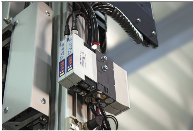
Централизованное генерирование вакуума посредством компактных эжекторов SMPi
